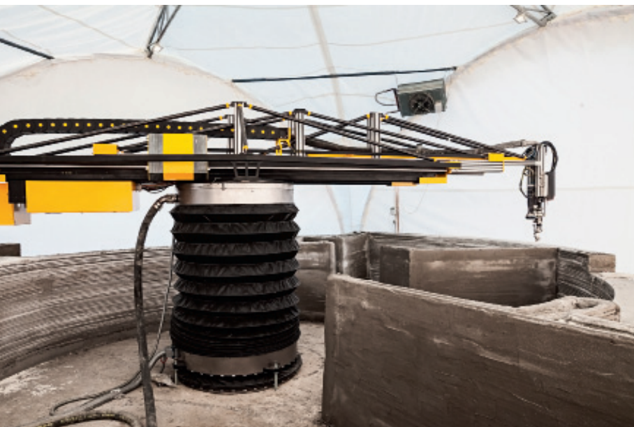
Ступино, Московская область. Принтер 3D для строительства конструкций от Aris Cog на дисплее в процессе презентации.
